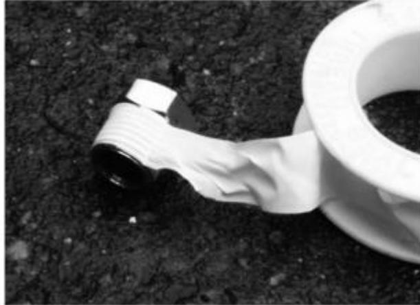
Con una llave inglesa, enrolla el casquillo hexagonal en el sentido de las agujas del reloj en el conjunto de la válvula. El hecho de que se apriete en un punto o en todo el recorrido depende de la combinación de roscas cónicas o paralelas. Si el casquillo hexagonal no encaja, consulta la sección de resolución de problemas y los anexos para conocer las alternativas. La rosca de conexión será casi siempre de 1/4" BSP.
