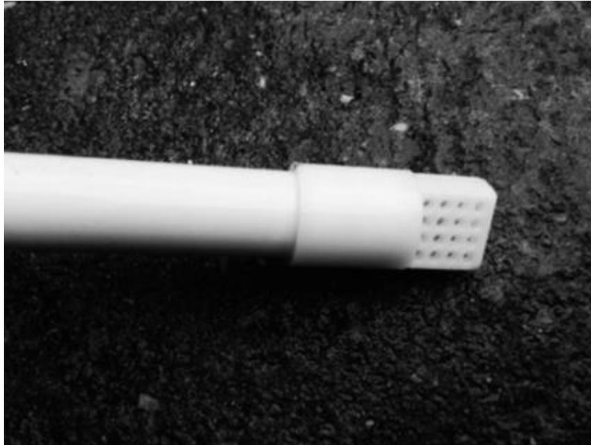
Desenrosca el filtro, si no se puede, utiliza una sierra de arco para cortar el extremo hasta exponer totalmente el diámetro interno del tubo del sifón. corta lo más cerca posible del extremo del tubo para no acortarlo.
