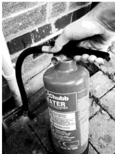
Algunos extintores de agua también contienen un aditivo de espuma, por lo que es mejor descargar todos los extintores de agua a una alcantarilla, no sólo los de espuma.
