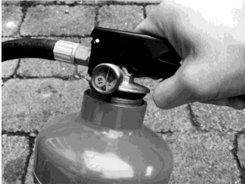
Levanta y saca el conjunto de la válvula y el tubo del sifón.
