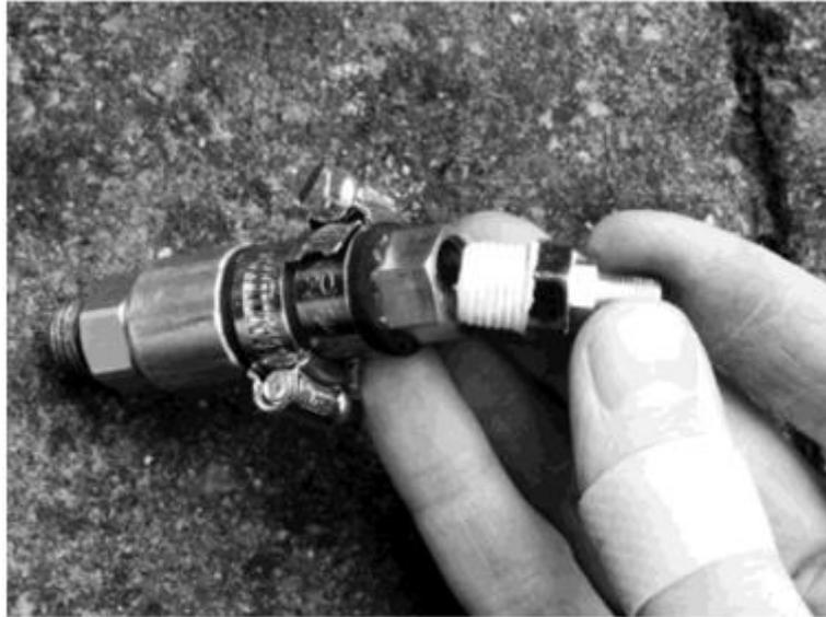
Con una llave ajustable, aprieta más el casquillo hexagonal. Es posible que necesites una segunda llave ajustable para sujetar la tuerca hexagonal en el conector del extremo de la manguera.
