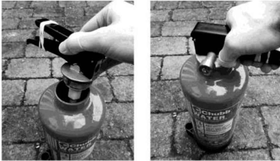
Enrolla en el sentido de las agujas del reloj todo lo que pueda. Coloca el cilindro en posición horizontal (puede que también quieras tapar primero el punto de conexión de la manguera para evitar que se filtren los líquidos). Agarra el cilindro con una mano y con la otra empuja hacia abajo las palancas de accionamiento para apretar más el conjunto de la válvula. Si te resulta difícil, golpea con cuidado las palancas con un mazo de goma, pero intenta que no sea necesario.
