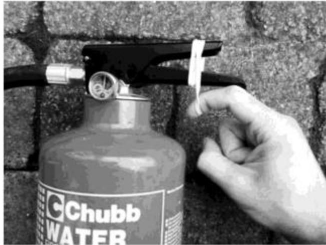
Con el extintor en posición horizontal y una mano sujetando el cilindro, empuja con la otra mano las palancas de mando hacia abajo para comenzar a aflojarlas en sentido contrario de las agujas del reloj.
