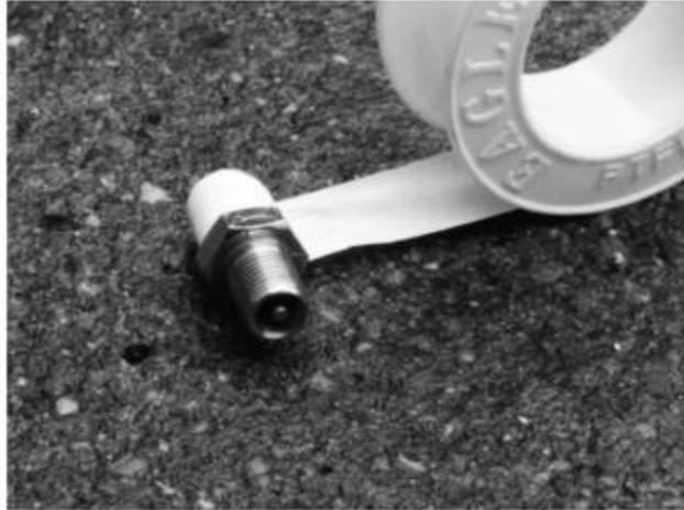
Aprieta la válvula schrader en el sentido de las agujas del reloj en el casquillo hexagonal usando una llave inglesa. Probablemente nunca la desmontarás, así que apriétala bastante.
