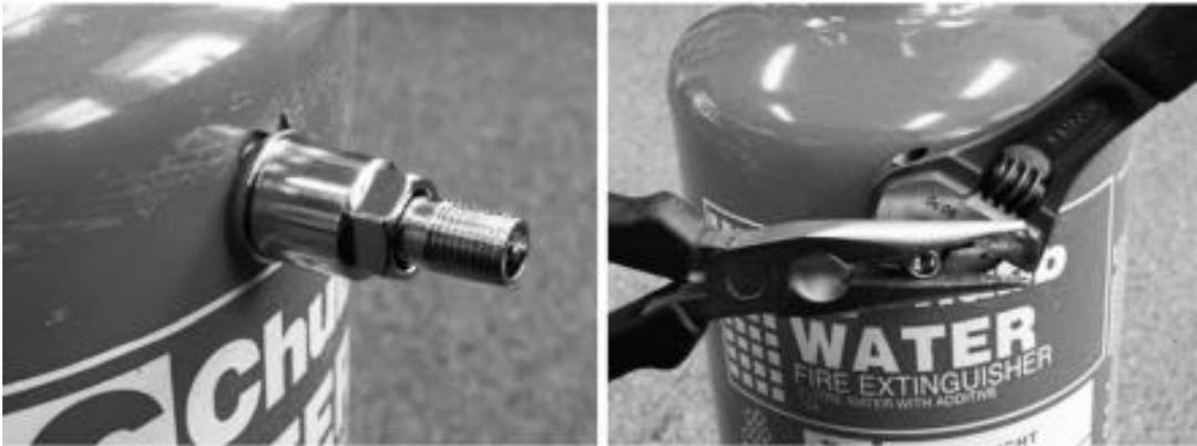
Vuelve a colocar el tapón de la válvula girándolo en el sentido de las agujas del reloj. Cuando finalmente se presurice, aprieta aún más el tapón con pinzas. Es una defensa secundaria contra fugas de aire/líquido. La modificación está ahora completa.
