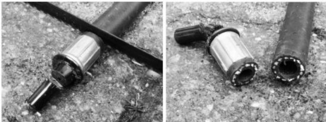
El problema es que el interior de la manguera tendrá un diámetro interno mayor que el del conector de la manguera, especialmente en una manguera de chorro. Se producirá un chorro aceptable depende de lo grande que sea la diferencia, pruébalo.
